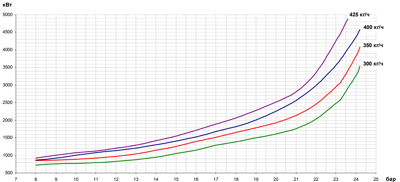
Диаграмма производительности форсунки в зависимости от давления в обратном топливопроводе при давлении насоса 25 бар
