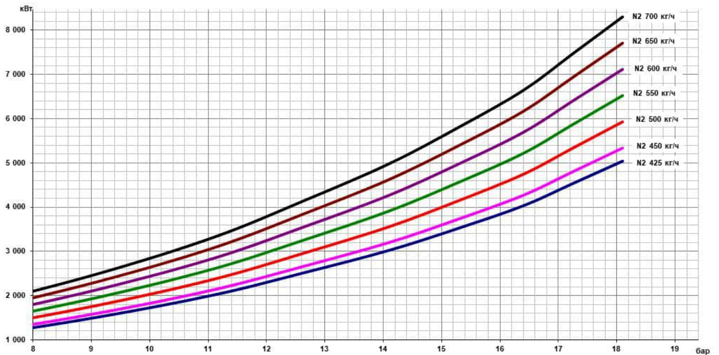
Диаграмма производительности форсунки в зависимости от давления в обратном топливопроводе при давлении насоса 25 бар
